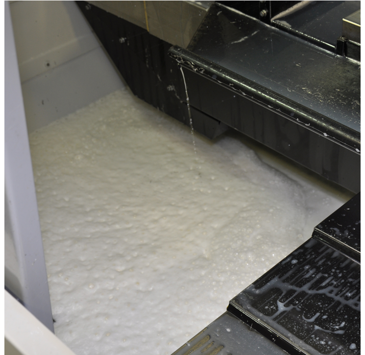
La espuma en fluidos para metalurgia pueden ser una necesidad o un gran dolor de cabeza, siendo un gran dolor de cabeza la mayoría del tiempo. La espuma no lubrica bien, enfría mal, aumenta el volumen del fluido, agrega problemas de olor y, lo más importante, puede dañar la plomería de la máquina.
