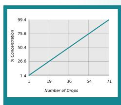
% Concentration = No. of Drops x Titration Factor  $\label{eq:Titration} \mbox{Titration Factor} = 1.40$
