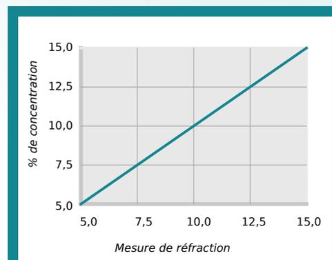
% de concentration = Mesure de réfraction x Indice de réfraction
