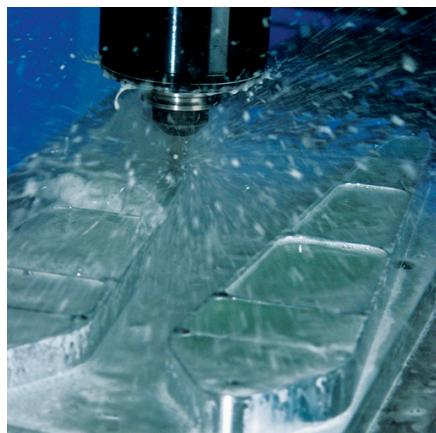
半合成液含高精炼矿物油和润滑添加剂。半合成液结合了全合成液的冷却性和乳化液的润滑性、以及良好的残留物状态性能、使得半合成液成为当今市场上使用普遍的冷却液品种。
