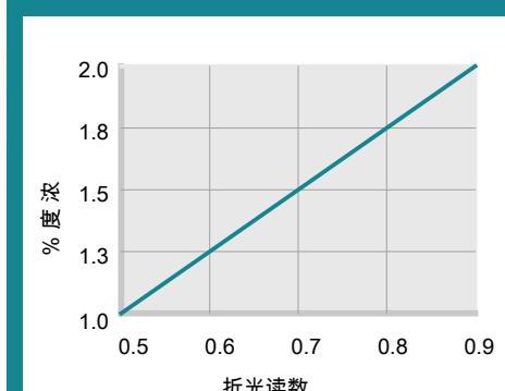
$$\text{浓度 \%} = \text{折光读数} \times \text{折光系数} \\ \text{折光系数 \%} = 2.2$$
